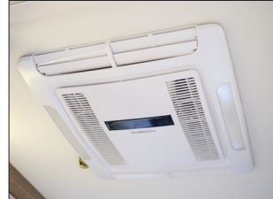
Klimaanlage im Wohnbereich Dometic Fresh Jet FJX4 2200
