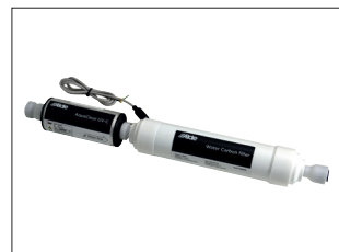
"Wasserreinigung" Alde AquaClear UV-C (für Heizkessel Alde Compact 3030). Wirkungsvolle Wasserreinigung schützt die Gesundheit des Benutzers auf umweltfreundliche Weise. Unerwünschte Keime werden abgetötet, Pestizide und Chemikalien werden ausgesondert. Das Wasser wird durch das UVC-Licht von Leuchtdioden desinfiziert. Danach durchläuft es einen Kohlefilter, der für ein geruchs- und geschmacksneutrales Wasser ohne Eintrübungen sorgt.
