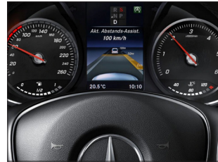
DISTRONIC Adaptive Geschwindigkeitsregelung. Der adaptive Abstandsassistent DISTRONIC hält den vom Fahrer eingestellten Abstand zum vorausfahrenden Fahrzeug konstant ein. Die DISTRONIC ist beim Imperial serienmäßig, beim Novum, Royal und Crown ist sie als Zubehör erhältlich.
