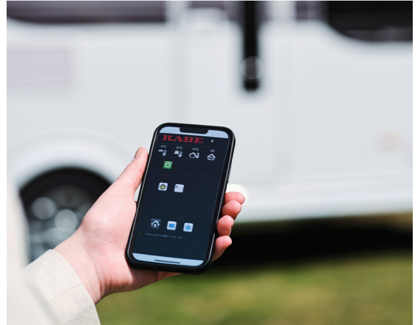
KABE Smart D Remote. Mit KABE Smart D Remote* können Sie die Bedientafel Ihres Wohnwagens von jedem beliebigem Ort aus über eine App steuern. KABE Smart D Remote basiert auf einem 4G-Router mit internen Antennen (externe Antenne als Zubehör erhältlich). Damit können Sie nicht nur die Heizung und die Beleuchtung steuern, sondern auch weitere Funktionen und Alarmmeldungen des Wohnwagens über das Handy kontrollieren. Zudem haben Sie auch unterwegs Zugriff auf eine gute, drahtlose Internetverbindung.
