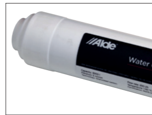
"Wasserreinigung" – Alde AquaClear UV-C (für Heizkessel Alde Compact 3030). Wirkungsvolle Wasserreinigung schützt die Gesundheit des Benutzers auf umweltfreundliche Weise. Unerwünschte Keime und Legionellen werden abgetötet, Pestizide und Chemikalien werden ausgesondert. Das Wasser wird durch das UV-C-Licht von Leuchtdioden desinfiziert. Danach durchläuft es einen Kohlefilter, der für ein geruchs- und geschmacksneutrales Wasser ohne Eintrübungen sorgt.
